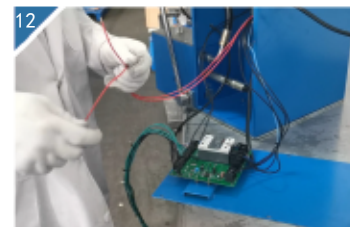
12 将泵的电源线紧到电路板上。
