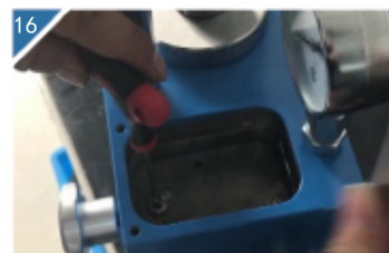
16 用细板子顶开单向阀的滚珠并摇动压把，把气体放出。
