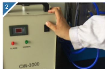
2 加热超过300℃，需要打开水冷机对压片机进行保护。
