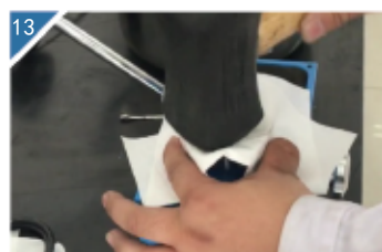
13 用橡胶锤将大油缸砸回到底部。
