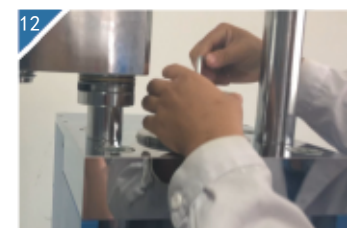
12 松开压杆上的放气螺丝。
