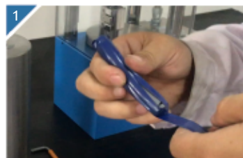
1 将样品装入橡胶模具中封好。
