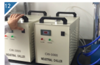
12 打开水冷机，将加热板冷却。
