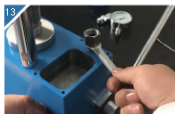
13 装上压力表连接柱。
