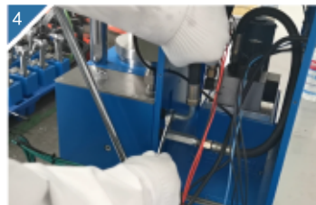
4 拆下回油油管。
