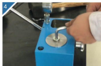
4 用8mm内六角板子松开大油缸锁母。
