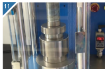
11 压片机开始按设定压力进行加压。
