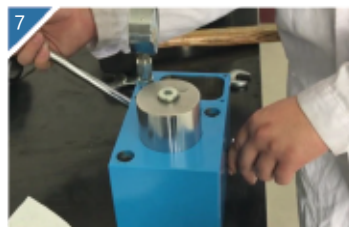
7 紧上放油阀杆，摇动压把用液压将大油缸顶出。
