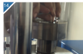
14 用压杆的拆卸螺丝，取下压杆。
