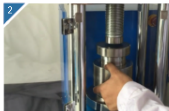
2 将模具放入压片机中。
