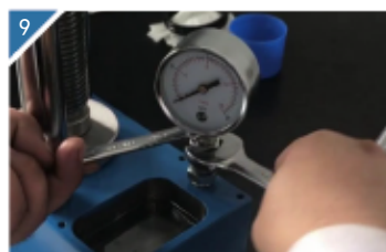
9 将压力表和压力表柱分开。
