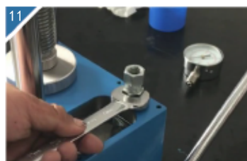
11 将压力表连接柱取下。
