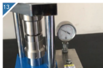
13 将压力压到500kg左右，将封好的电池分离。
