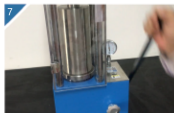
7 摇动压把将压力压到所需压力。
