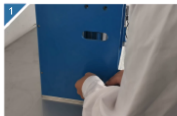
1 拆下压片机侧挡板。
