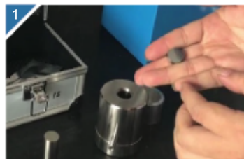
1 将模具套和模具底组装好，放上模具片。
