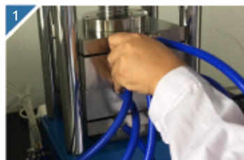
1 将样品放置到模具中，拧紧丝杠。
