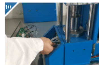
10 拔下电路板上的排线。
