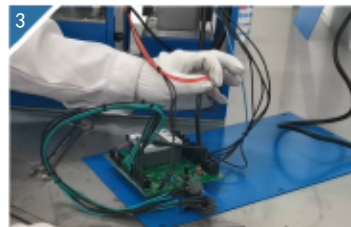
3 拆下泵的电源线。
