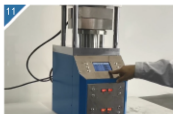
11 设备加到设定压力后停止加压。
