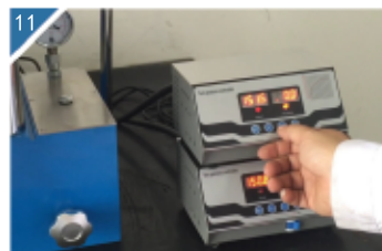
11 将设定温度设置成“0”停止加热。
