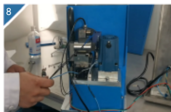
8 接上泵和电磁阀的电源线。
