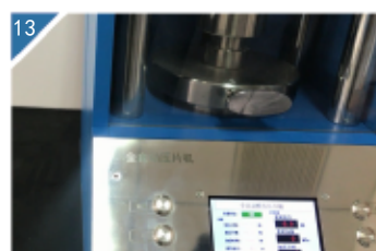
13 压片机开始加压，当油缸到限位或压力到10吨，设备会自动泄压。
