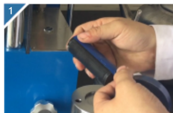
1 将样品放入橡胶模具中。
