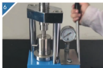
6 摇动压把加压，压到所需压力。
