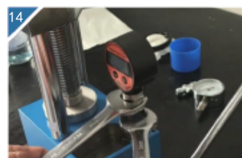
14 将数字表和数字表连接柱紧固在一起。
