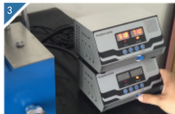
3 打开温控器的电源开关。
