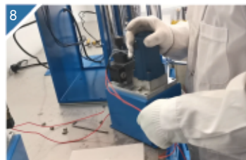
8 换上新的液压泵。
