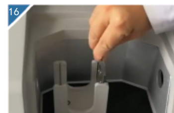
16 将样品放入光谱仪中进行检测。
