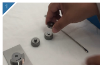
1 将模具套和模具底组装好，放上模具片。
