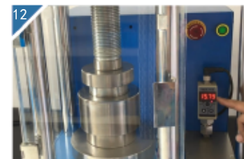
12 压片机加到设定压力停止加压，并保压。
