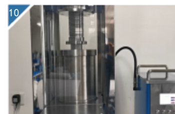
10 设备加到设定压力，保压一段时间后自动泄压。
