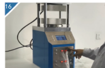
16 停止制样后，需要关闭加热板。
