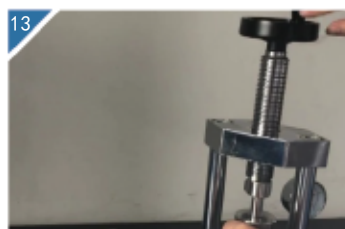
13 用压片机丝杠将模具中样品顶出。
