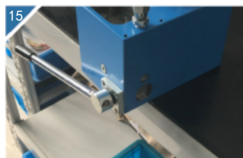
15 如果不上压，需要将柱塞上面的螺丝松开并摇动压把放出一部分油，再紧上高压阀的螺丝。
