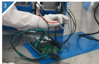
3 拆下泵的电源线。
