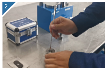
2 将垫片放到模具套中。
