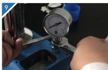
9 将压力表和压力表柱分开。
