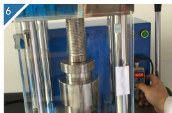
6 再按▲/▼键设定压力停止数值，再按mode键返回菜单。
