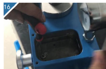
16 用细板子顶开单向阀的滚珠并摇动压把，把气体放出。
