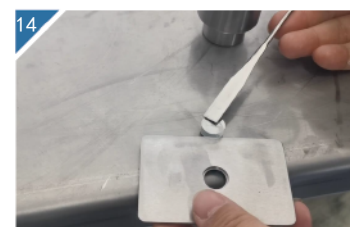
14 将样品放入磁力样品架中。
