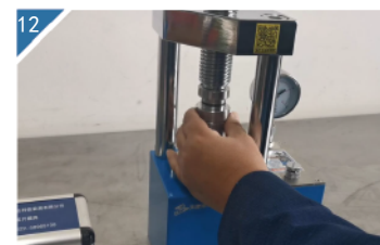
12 在压片机中用丝杠将样品顶出。
