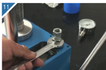
11 将压力表连接柱取下。
