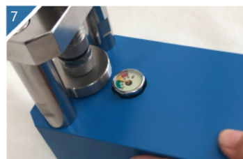
7 将压力压到所需压力。
