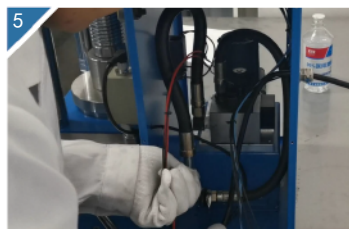
5 拆下进油油管。
