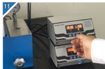
11 将设定温度设置成“0”停止加热。
