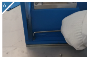
6 拆下泵的固定螺丝。
