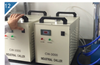
12 打开水冷机，将加热板冷却。
