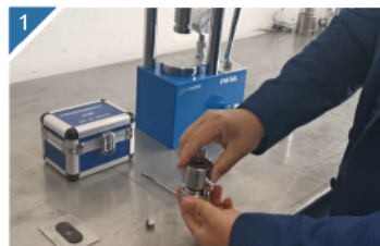
1 将模具套和模具底组装好。
