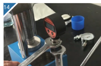
14 将数字表和数字表连接柱紧固在一起。
