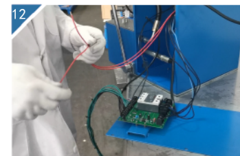
12 将泵的电源线紧到电路板上。
