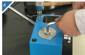
4 用8mm内六角板子松开大油缸锁母。
