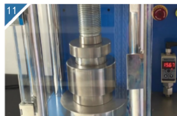
11 压片机开始按设定压力进行加压。
