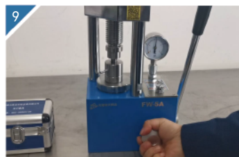
9 保压一段时间，松开放油阀杆，泄掉压力。
