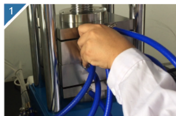
1 将样品放置到模具中，拧紧丝杠。
