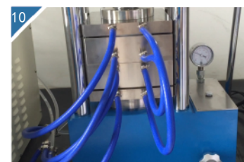
10 将压力压到所需压力，并保压一段时间。
