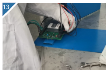
13 如电路板损坏可以更换电路板。
