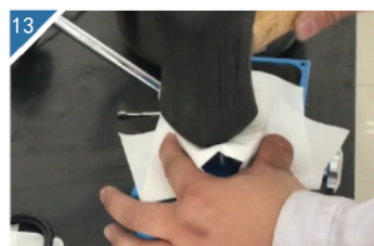
13 用橡胶锤将大油缸砸回到底部。
