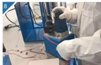
8 换上新的液压泵。
