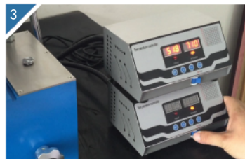
3 打开温控器的电源开关。
