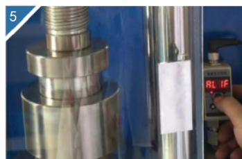
5 选择RL1F，再按mode键进入压力设置界面。
