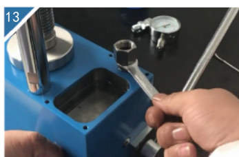
13 装上压力表连接柱。
