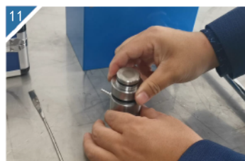
11 将模具底反过来，盖在模具套上。
